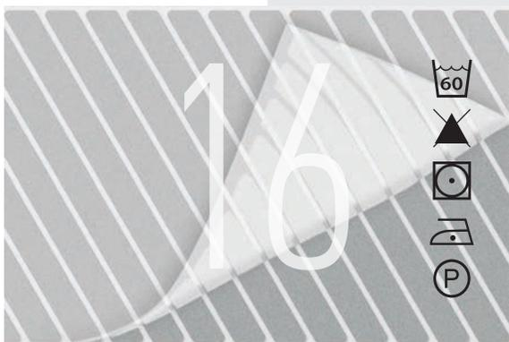
Сегментированная светоотражающая огнестойкая лента XM-8011C прижигается к огнезащитной одежде или одежде пожарных. Она эластична и позволяет воздуху лучше циркулировать сквозь одежду. XM-8011C производится из высокотехнического материала. Рекомендуется заранее тестировать на ткани. Также мы советуем постирать готовое изделие вместе с лентой.
